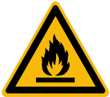
Warnung vor feuergefährlichen Stoffen
