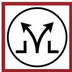
Rauch- und Wärmeabzugsanlage, Bedienstelle
